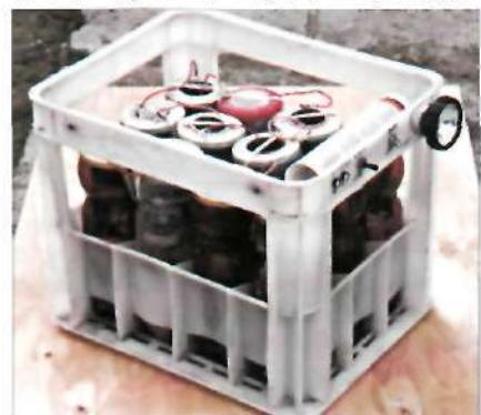
из-под пива или любых остатков фольги, крышки (пластмассовые или металлические), обрезки стандартных труб. Несколько соединенных проводами «грибов» вставляются в стандартную пластиковую или даже картонную тару.
